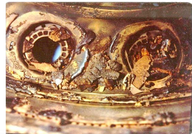
Combustor damage due to VA
